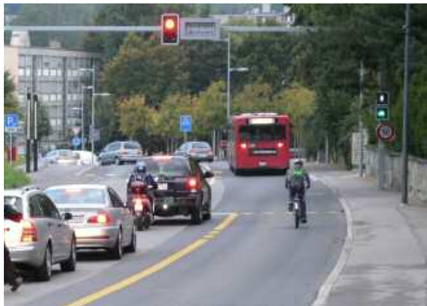
Abb. 40: Beispiel einer Lichtsignal-Pförtneranlage mit Bevorzugung ÖV
